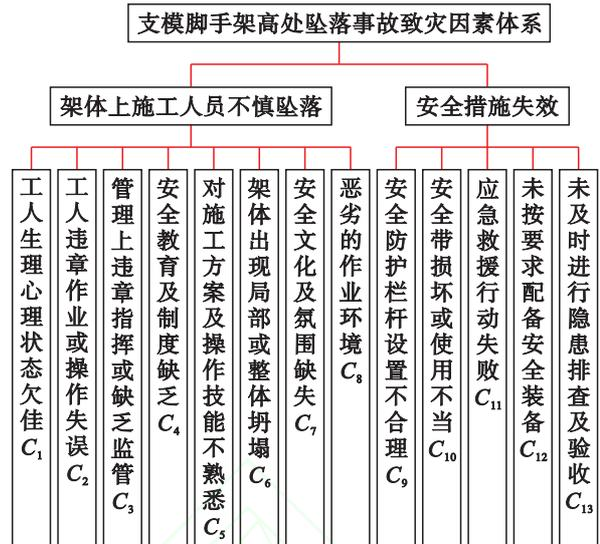
图 1 支模脚手架高处坠落事故致灾因素体系
