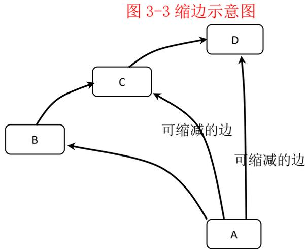
上图中的  $A \rightarrow C$ 、 $A \rightarrow D$  的有向边可以删除，因为  $A \rightarrow B \rightarrow C$  这条路径包含有  $A \rightarrow C$  的可达状态。从可达的概念来阐释，如果两要素之间存在两条路径，其中直接的路径是可以删除的。现实世界中经常出现缩边处理，比如不要越级进行指挥。
