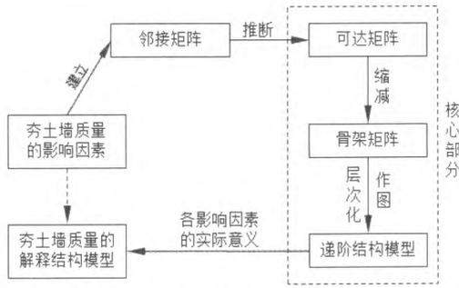
图1 夯土墙质量影响因素的解释结构模型的构建示意图
